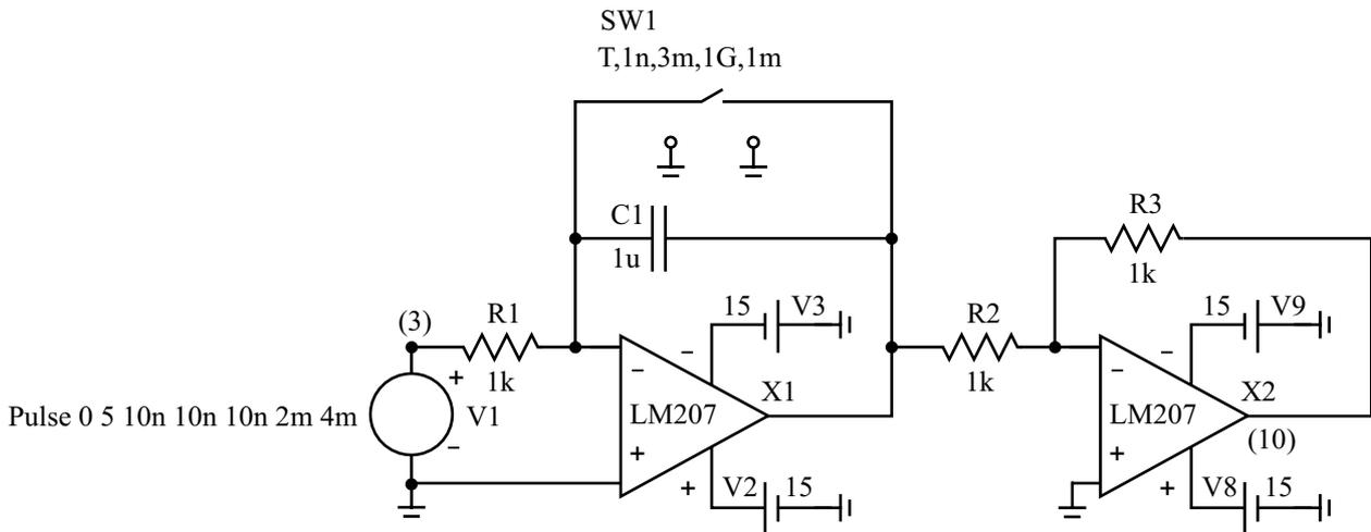
Wie das Bild 9.17 zeigt, fällt die Spannung am Ausgang des Integrierers linear ab. In der Schaltung 15.20 sorgt der nachgeschaltete OV2 mit dem Spannungs-Übertragungsfaktor  $T_u = -1$  dafür, dass seine Ausgangsspannung linear ansteigt.
